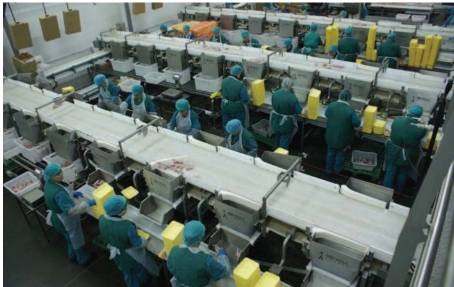
Zespół obsługujący sekcje systemu porcjowania wagowego Ishida Weigh-Batcher. Ośmioro ludzi przy każdym stole może swobodnie pakować elementy z 10 500 sztuk ptaków na godzinę. Pozostałe 8 stanowisk przy stole zapewnią dosyć miejsca dla przyszłego zwiększenia produkcji
