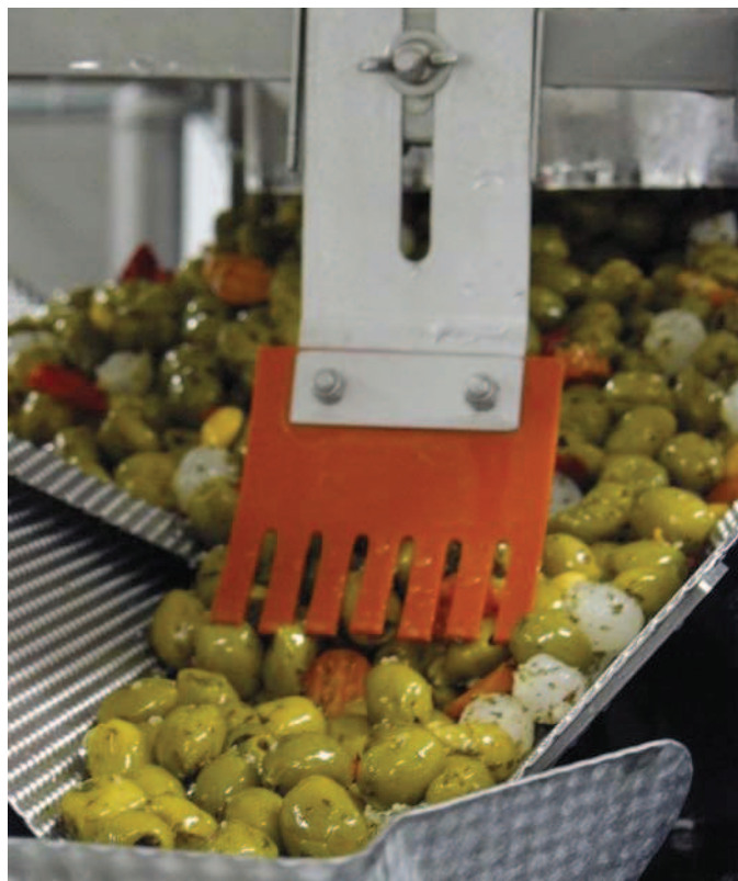
Na naważarce CCW-RS-210W-S system wibracyjny AFD firmy Ishida automatycznie reguluje równomierny przepływ produktu do zasobników ważących
