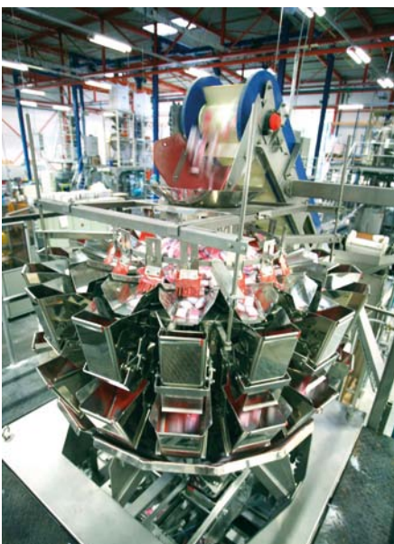
Naważarka wielogłowicowa Ishida zajmuje dużo mniej miejsca niż maszyny liczące, które zastąpiła
