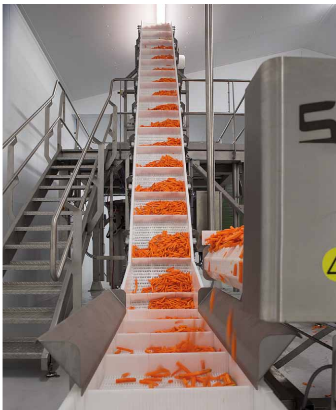
Linia podająca porcje marchwi do naważarki
